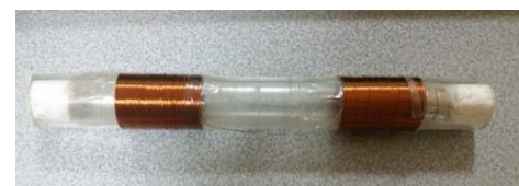
Fig.6 (a) 連続巻きのコイル構造 (LTC 構造) と (b) 両端に集中させたコイル構造 (BEC 構造) の装置図
