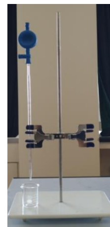
Fig.1 滴下法による CMC 算出実験装置
