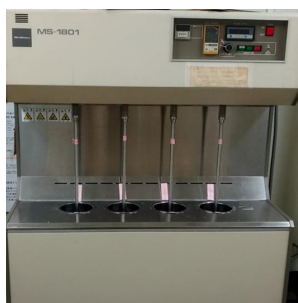
Fig.2 洗浄力測定の実験装置
