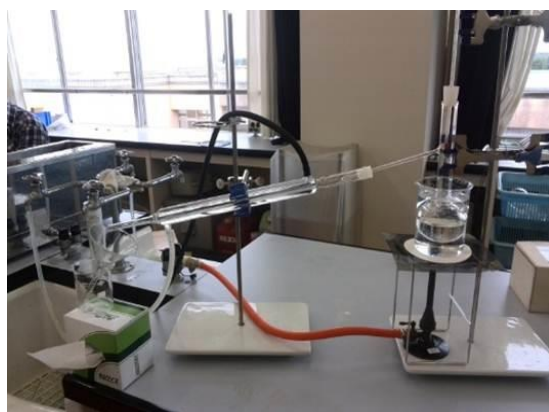
図3 常圧蒸留装置
