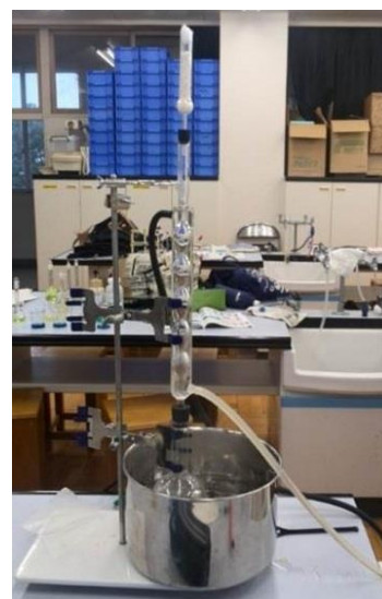
図1 加熱還流装置
