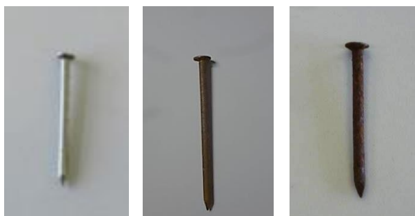
錆の無い Fe 釘 錆の少ない Fe 釘 錆の多い Fe 釘
