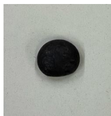
図8 日立市のカラミから作製したカラミ煉瓦
