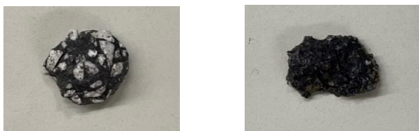
(a) 砂鉄、石英、 \text{CaCO}_3 を使用して作製した試作品 (b) 砂鉄、高温石英、 \text{CaCO}_3 を使用して作製した試作品
