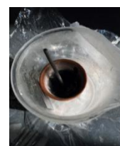
図13 冷凍庫に入れた後のルクランシェ電池
