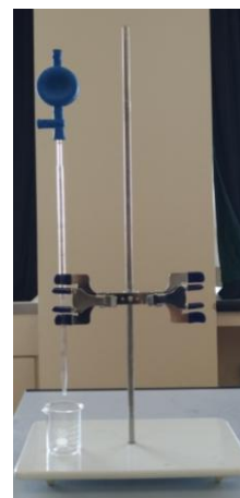
Fig. 1 滴下法による CMC 算出実験装置
