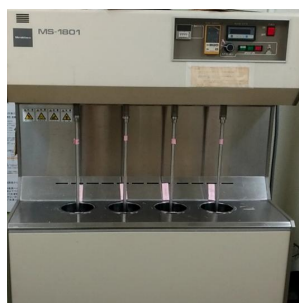
Fig.2 洗浄力測定の実験装置
