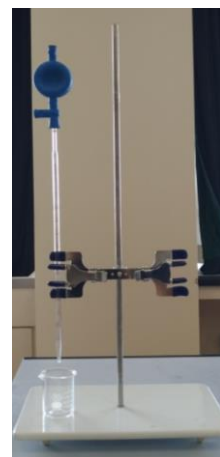
Fig. 1 滴下法による CMC 算出実験装置
