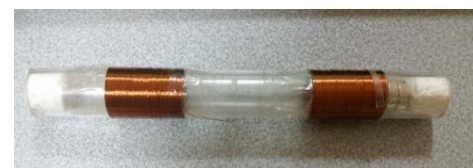
Fig.6 (a) 連続巻きのコイル構造 (LTC 構造) と (b) 両端に集中させたコイル構造 (BEC 構造) の装置図
