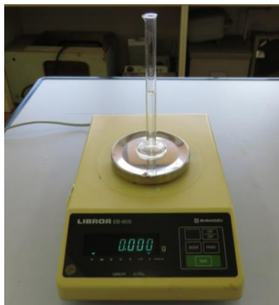
図2 Fe 釘と Cu 釘の質量と体積を測定する装置
