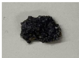
(b) 砂鉄、高温石英、 \text{CaCO}_3 を使用して作製した試作品
