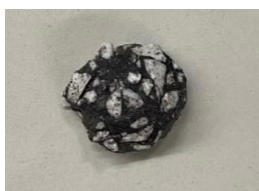
(a) 砂鉄、石英、 \text{CaCO}_3 を使用して作製した試作品
